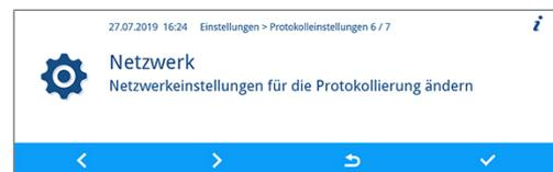
Es können Einstellungen für MELAtherm-IP, Verbindungsart, FTP-Passwort, TCP-Port, Computer-IP, MELAprint-EDM-IP, Gateway-IP und Subnetzmaske vorgenommen werden.
